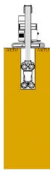
②掘削開始、カッター先端よりセメント系懸濁液とエアを吐出しながら掘削攪拌造成を行う
