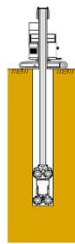
③セメント系懸濁液とエアを吐出しながら攪拌引上げを行う
