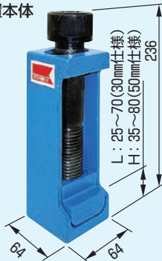
重量: 約4kg 耐力: 20t(30mm仕様)、30t(50mm仕様)【実験値】 ※能力不足時は複数使用
